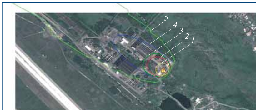
▲ Рис. 3. Зоны распространения хлорного облака в случае полного разрушения контейнера:
